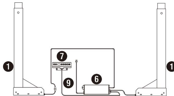
**M.** Drehen Sie den montierten Schreibtisch auf die rechte Seite. Fassen Sie den Schreibtisch mit zwei Personen am Fuß (nicht an der Tischplatte) an und drehen Sie den Schreibtisch auf die rechte Seite. Stellen Sie die Nivellierbolzen an den Füßen (Teil 8) nach Bedarf ein.
