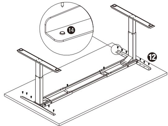
J. **ZIEHEN SIE IM FOLGENDEN SCHRITT DIE SCHRAUBEN NICHT ZU FEST AN. ÜBERMÄSSIGES ANZIEHEN KÖNNTE DAZU FÜHREN, DASS DER KUNSTSTOFF AN DEN KOMPONENTEN BRICHT.**
