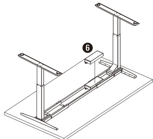
**K. ZIEHEN SIE IN DIESEM FOLGENDEN SCHRITT DIE SCHRAUBEN NICHT ZU FEST AN. ÜBERMÄSSIGES ANZIEHEN KÖNNTE ZUM BRUCH DES KUNSTSTOFFS AN DEN KOMPONENTEN FÜHREN.**
