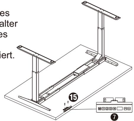
**L.** Schließen Sie die Kabel wie in der Abbildung unten dargestellt an. Verwenden Sie die selbstklebenden Kabelklemmen (Teil 13), um die Anschlusskabel zu sichern, damit sie nicht durchhängen.
