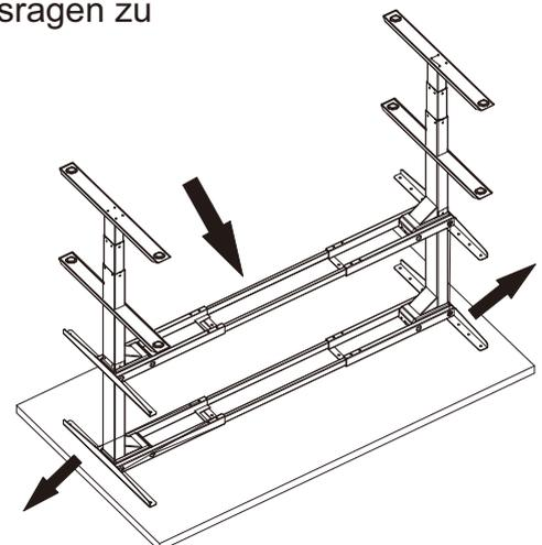
H. Sichern Sie die Mittelschienen an beiden Enden mit 8 Maschinenschrauben (Teil 17), 4 Stück pro Seite.
