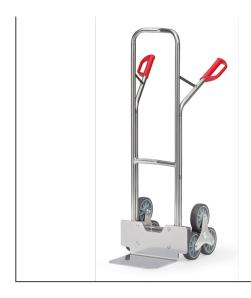
Aus Aluminiumrohr mit Aluminiumschaufel, handliche Schweißkonstruktion. Sicherheitsgriffe. Mit 2 dreiarmigen Rad-Sternen, jeweils 3 TPE-Räder 160 mm Ø, Naben mit Kugellager. Bügel oben und Querstreben durchgebogen. Für den sicheren Transport von runden Gütern, wie Rollen, Kannen. Eimern usw.
